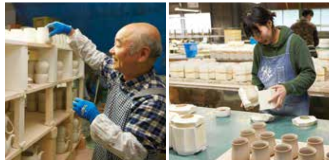
〈鑄込み成形:石膏型に泥状の粘土を注入し器を成形する。人の手によって一つずつ、その時々々の器の状態に寄り添った力強さをもって丁寧に作り、そして仕上げます。〉
