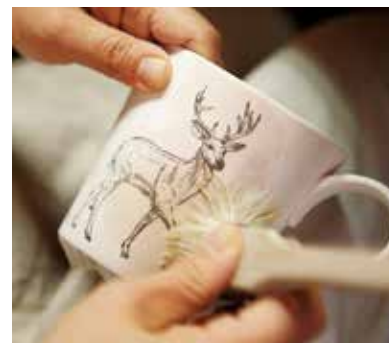
〈銅版転写による下絵付:和紙に描かれた柄を筆と水のみで器に写しとります。〉
